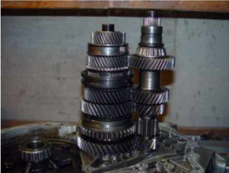
3. Vorgelegewelle und Hauptwelle nach abgebauter Gangschaltung, ohne Schaltgabeln und -gestänge
