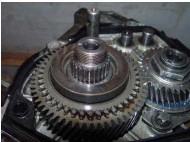
4. Synchronring entfernt, konischer Gleichlaufring auf großem Zahnrad sichtbar
