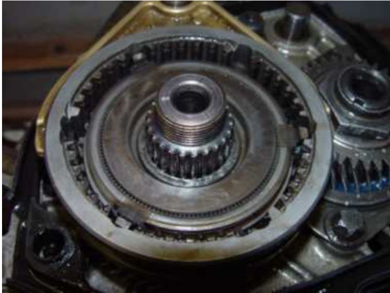
3. Synchronkern, Kugeln, Bolzen, Federn aus der Synchronisation entfernt. Sichtbar ist der Synchronring
