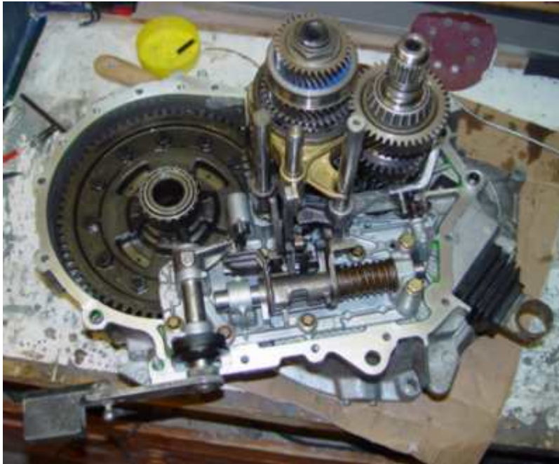
1. Bild vom Inneren des Getriebes, ohne Zahnrad für den 5. Gang auf der Hauptwelle
